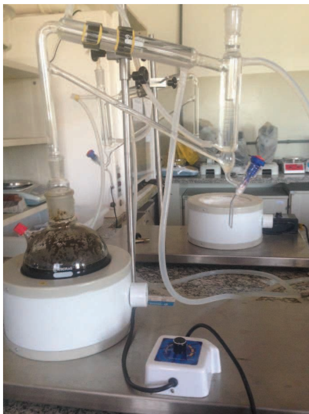
Figura 2: Aparelho tipo Clevenger utilizado na hidrodestilação.
