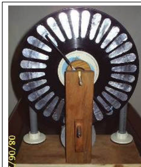
Figura 1: Experimento produzido para demonstrar fenômenos elétricos - Máquina de Wimshurst
