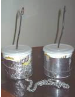
Figura 10 Garrafas de Leyden produzidas para armazenar as cargas coletadas
