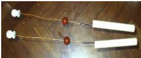
Figura 7– Terminais que serão encaixados nos coletores e que por onde sairão as descargas.
