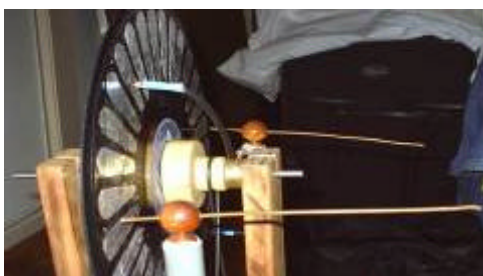
Figura 8 – Coletores que recolhem as cargas dos setores metálicos por indução.
