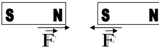
Não é possível separar os pólos de um ímã. Quando um ímã é quebrado, cada novo pedaço terá um pólo norte e um pólo sul. Para explicar a inseparabilidade dos pólos propõe-se um modelo em que um ímã é composto por inúmeros ímãs elementares (dipolos magnéticos) orientados.
