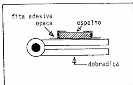
A dobradiça é colocada dentro de um recipiente de paredes não muito altas (bacia), contendo água. A posição do espelho em relação à luz solar pode ser regulada aumentando-se ou diminuindo-se a abertura da dobradiça (ângulo  $\alpha$ ), até que apareça projetado, contra o teto da sala ou contra uma parede, um largo espectro de luz solar, composto de cores muito vivas.
