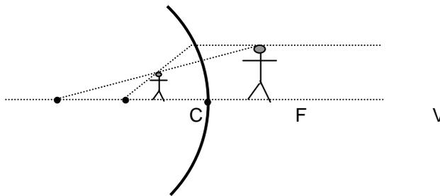
No espelho côncavo, se o objeto está colocado entre o foco e o vértice ( $s < f$ ) do espelho a imagem é virtual e direita.
