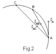
$\Delta t \to 0$ , a velocidade média tende à velocidade instantânea em  $t_A$  (ou no ponto A). Ainda, como as direções das velocidades médias são dadas pelas retas suportes dos vetores deslocamento correspondentes, é fácil ver que no limite  $\Delta t \to 0$  a velocidade linear (instantânea) tem direção tangente à trajetória no ponto A.
