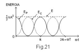
gravitacional na altura do centro de gravidade do corpo de massa m, a energia potencial gravitacional do sistema é nula. Mas existe uma energia potencial elástica, associada e localizada na mola. Levando em conta que a energia potencial elástica é dada por  $E_P = \frac{1}{2} kx^2$  e que, para um oscilador harmônico, x (t) = A cos  $\omega$ t, temos:
