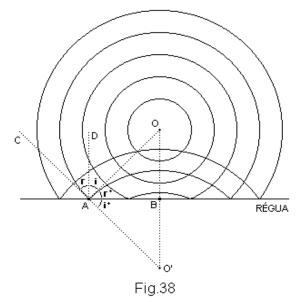
Seja i o ângulo de incidência, r, o ângulo de reflexão, i\*, o ângulo entre a régua e AO' e r\*, o ângulo entre a régua e AO. Como i + r\* =  $90^{\circ}$  e como r\* = i\*, já que os pontos O e O' são simétricos, temos:
