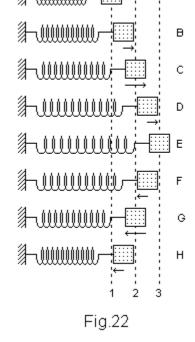
mola comprimida e corpo parado, linha 2, mola com seu comprimento de equilíbrio e corpo com velocidade máxima e linha 3, mola distendida e corpo parado. As flechas indicam o módulo e o sentido da velocidade nas configurações correspondentes.
