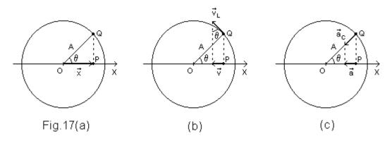
Se os pontos P e Q (Fig.17(a)) coincidem em t = 0, o ângulo do segmento OQ com o eixo X no instante posterior t é  $\theta = \omega t$ , onde  $\omega$  representa o módulo da velocidade angular do MCU. Então, cos  $\omega t = x/A$  ou:
