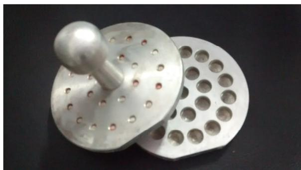
**Figura 2.** Replicador estéril utilizado para o plaqueamento das leveduras em diferentes meios de crescimento.
