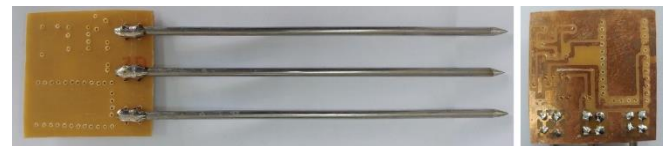
Figura 11- Fixação das hastes na placa de circuito
