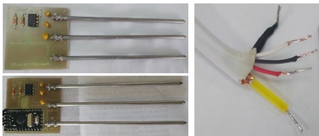
Figura 12- Soldagem do cabo e dos componentes eletrônicos
