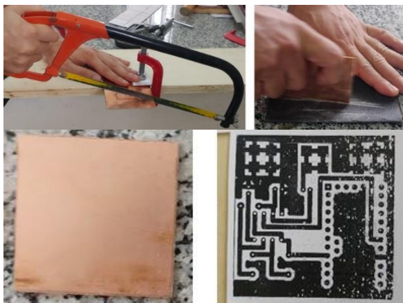
Figura 4- Corte e preparação da placa de fenolite para confecção do sensor
