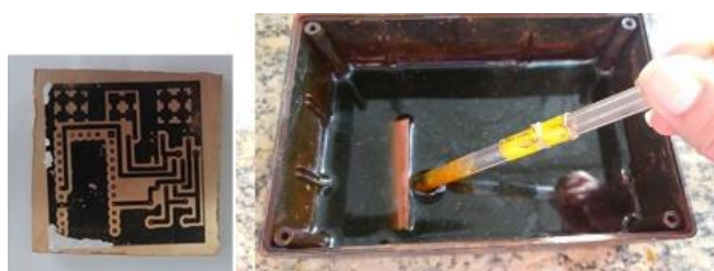
Figura 7- Processo de corrosão da placa
