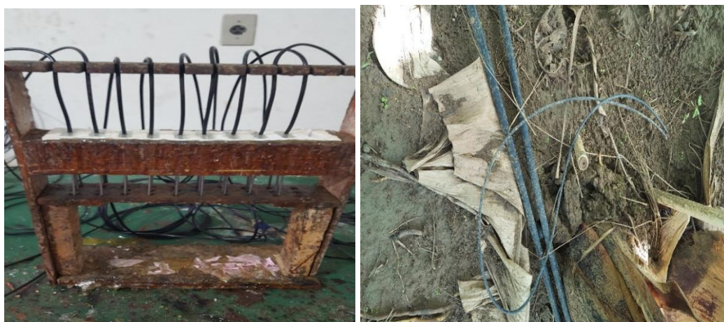
Figura 4. Sondas fabricadas (A) e instaladas (B) a 0,30 m de profundidade e 0,30 m da planta.
