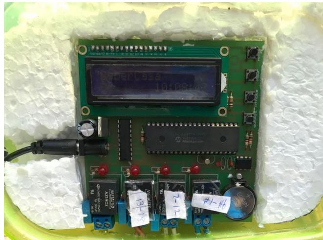
**Figura 4.** Controlador utilizado para o controle da irrigação por pulsos.
