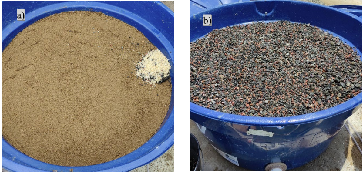
Figura 8. Leito filtrante e local onde foi instalado o último piezômetro (a); Leito totalmente preenchido e com a camada superficial de brita (b).
