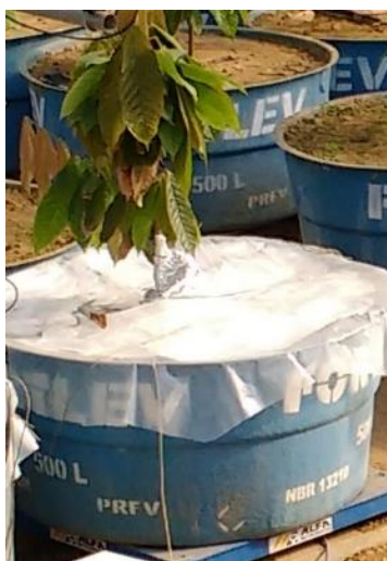
Figura 3. Lisímetro de pesagem com a superfície do solo coberta por lona plástica.
