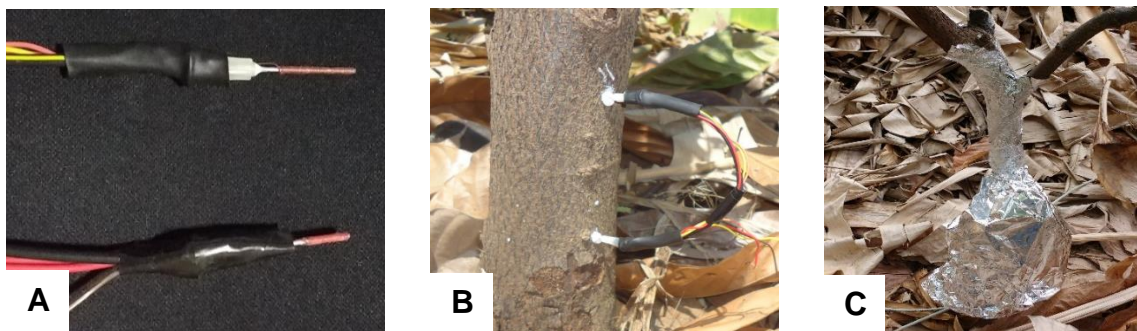
Figura 2. Detalhe das sondas de dissipação térmica com 2 e 1 cm de comprimento(A); detalhe da sonda inserida ao caule (B); Isolamento térmico do caule e da sonda feito com papel alumínio (C).
