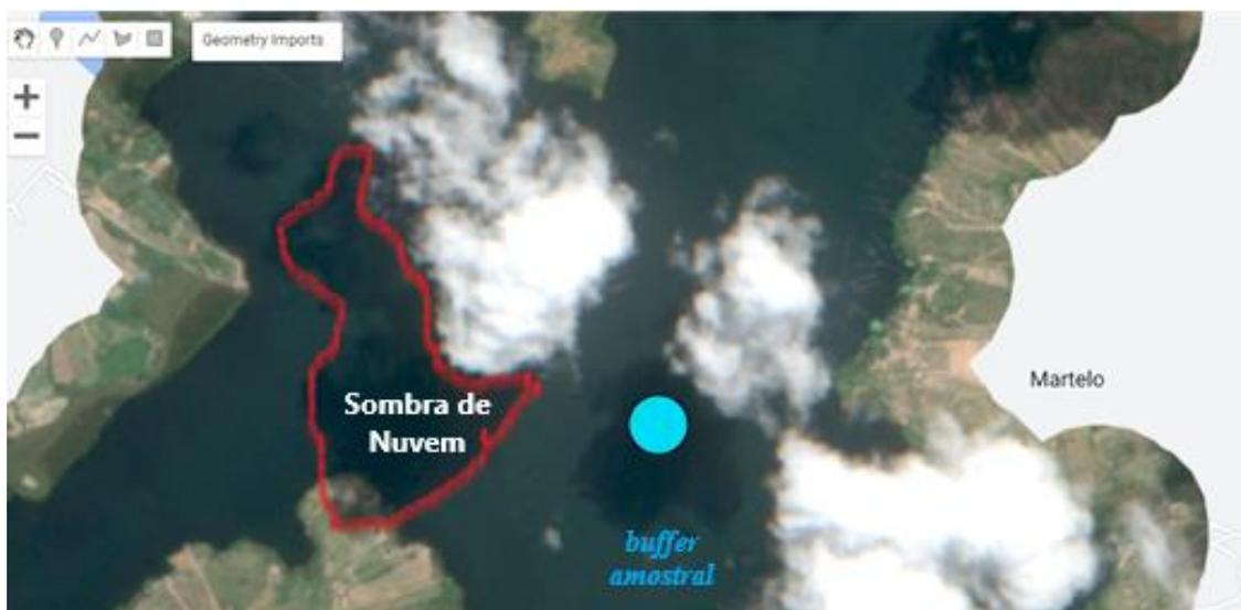
**Figura 30** – Sombra de nuvem no *buffer* amostral de qualidade da água do PMQA MOX 02, no reservatório de Xingó.
