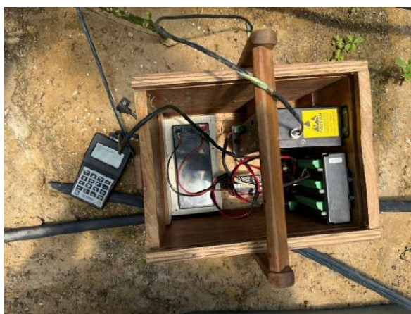
Figura 2 - Sensor capacitivo tipo TDR (Time-Domain-Reflectômetro) acopladas ao reflectômetro modelo TDR 100 da Campbell Scientific.
