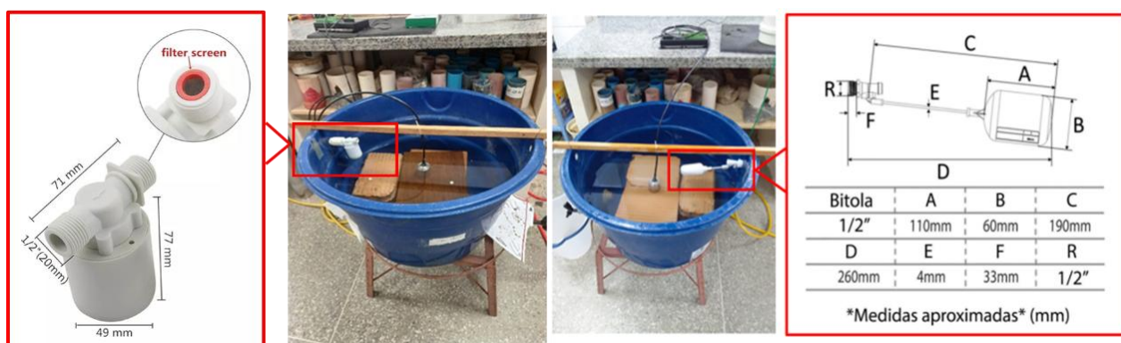
Figura 9. Sistema de teste das boias montado no LIAGRI-PPGEA-UFRB, boia 1 lado esquerdo e boia 2 lados direito (adaptado de carmonamultimarcas.com.br (2024); e produto.mercadolivre.com.br/MLB-4873985266-valvula-flutuaco-esfera-boia-caixa-dagua-alta-vazo-1/2-JM)
