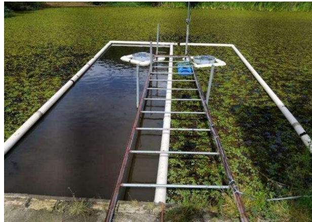
Figura 2. Experimento com os sensores acústicos, lado esquerdo águas livres de macrófitas (sensor 2073), lado direito monitoramento da evapotranspiração da salvinia (sensor 2074).
