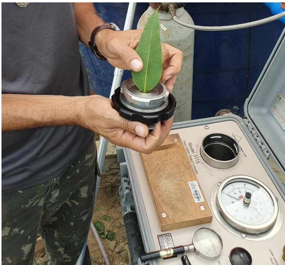
Figura 18. Medição do potencial hídrico foliar com a câmara de Scholander.
