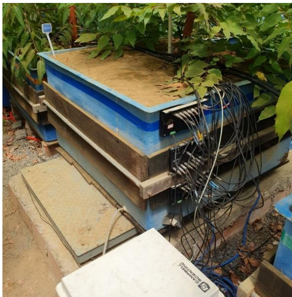
Figura 30. Lisímetro de pesagem do experimento com os instrumentos de coleta de dados.
