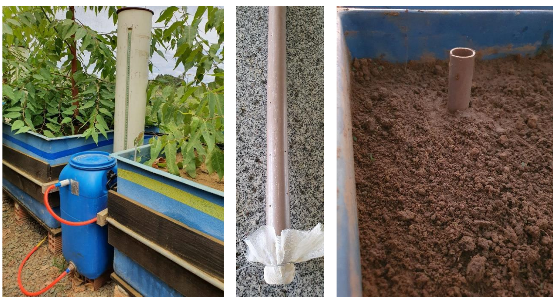
Figura 10. Lisímetro de lençol freático de carga constante e tubo de acesso inserido no solo para monitoramento do nível da água.
