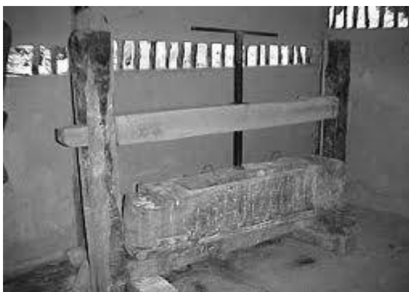
Figura 30 – Fotografia da prensa para massa da mandioca
