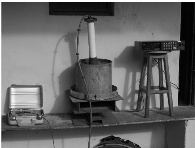
**FIGURA 5** – Vista geral do sistema de pesagem (monólito sobre a plataforma com uma sonda inserida para leitura e módulo indicador à direita)
