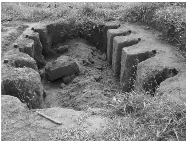
**FIGURA 6** - Vista parcial da trincheira utilizada, com os tubos de acesso instalados
