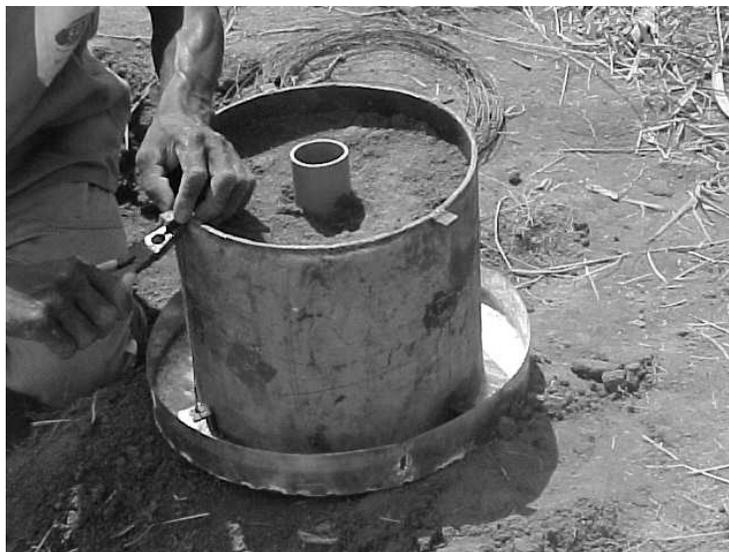
**FIGURA 4** – Monólito com tubo de acesso instalado e detalhe de fixação da base metálica.
