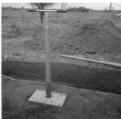
**FIGURA 7** – Instalação de um tubo de acesso
