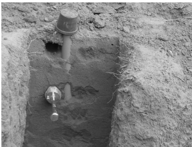
**FIGURA 8** – Vista da retirada das amostras indeformadas
