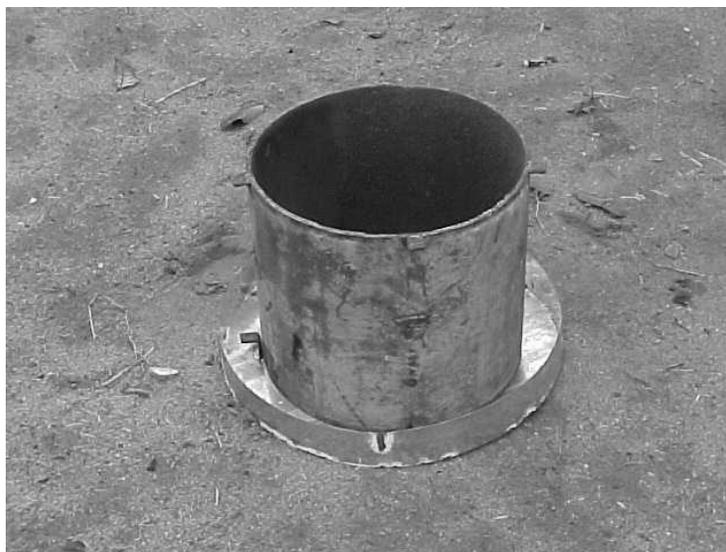
**FIGURA 2** – Molde para retirada de monólito
