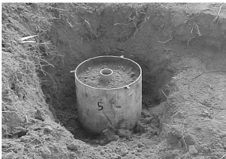
**FIGURA 5** – Exemplo de monólito para calibração de sonda de capacitância
