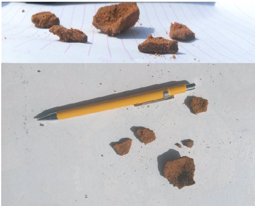
Figura 4: Concreção de ferro encontrada em massa de Argissolo Amarelo dos Tabuleiros Costeiros em Inhambupe – Ba
