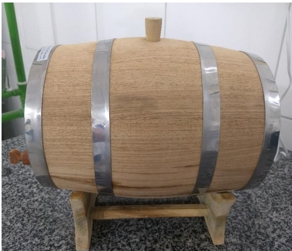
Figura 1. Vinagreira (barril acetificador) de madeira de carvalho para produção de vinagre pelo processo de Orleans.
