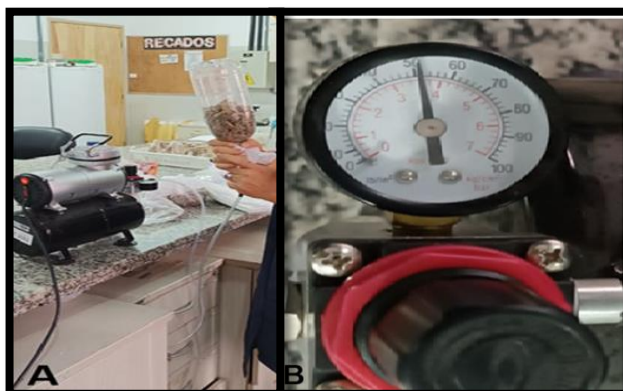
Figura 6 - (A) Análises de Durabilidade dos péletes (PDI); (B) Compressor de ar com pressão de 50 psi para realização do PDI.
