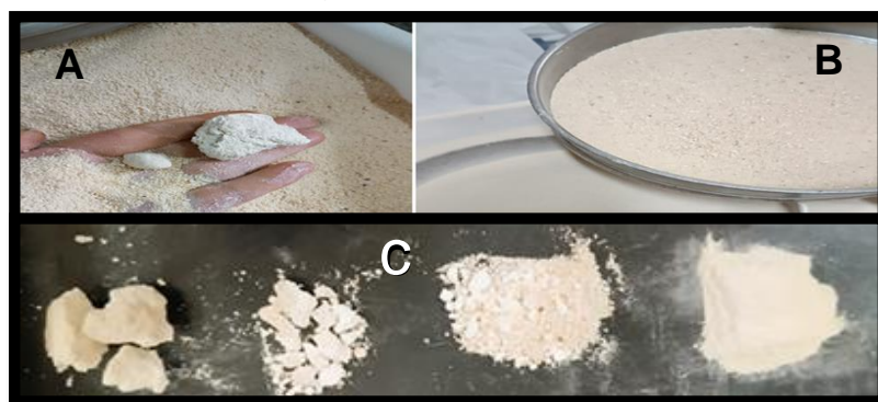
Figura 8- Variações de granulometria observadas em amostras de crueira doadas por produtores de mandioca do Município de Cruz das Almas. (A) Padronização da granulometria da crueira com peneira de 2mm (B). Granulometria final utilizada para aglutinação dos péletes de mucilagem de sisal desidratada (C).
