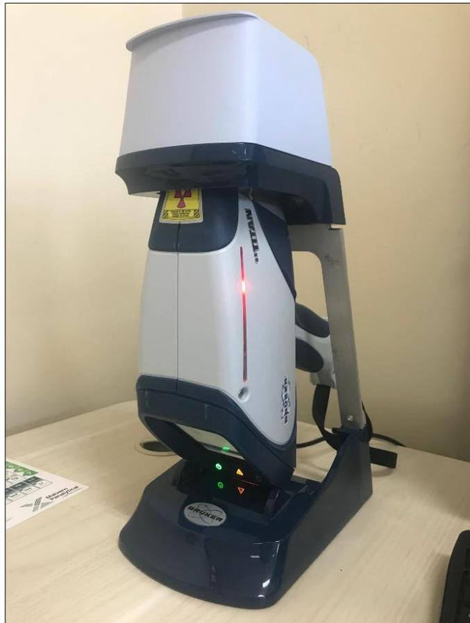
Figura 3 - Espectrômetro XRF Bruker Titan 600
