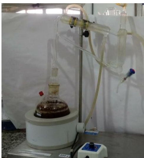
FIGURA 2. Equipamento Clevenger utilizado para hidrodestilação do óleo essencial.
