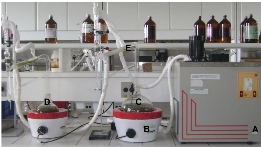
Figura 6. Refrigerador do sistema (A); Manta aquecedora (B); Balão volumétrico 5l (C); Balão volumétrico 3l (D); Aparelho Clevenger (E). Fonte: SUZART 2013.
