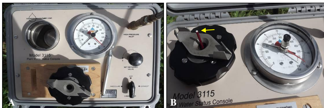
Figura 1. Câmara de pressão e manômetro da bomba Scholander (A); exudação de seiva do ramo para medição do potencial hídrico (B).
