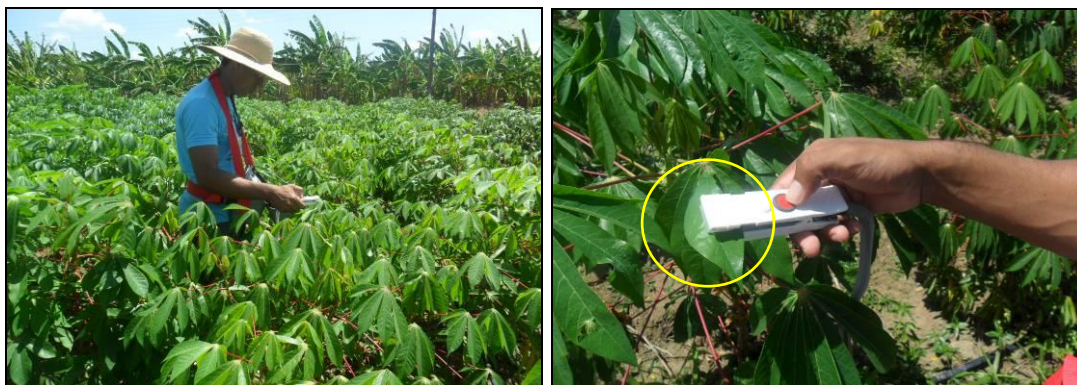
Figura 2: Medidas de porometria com auxilio de porômetro
