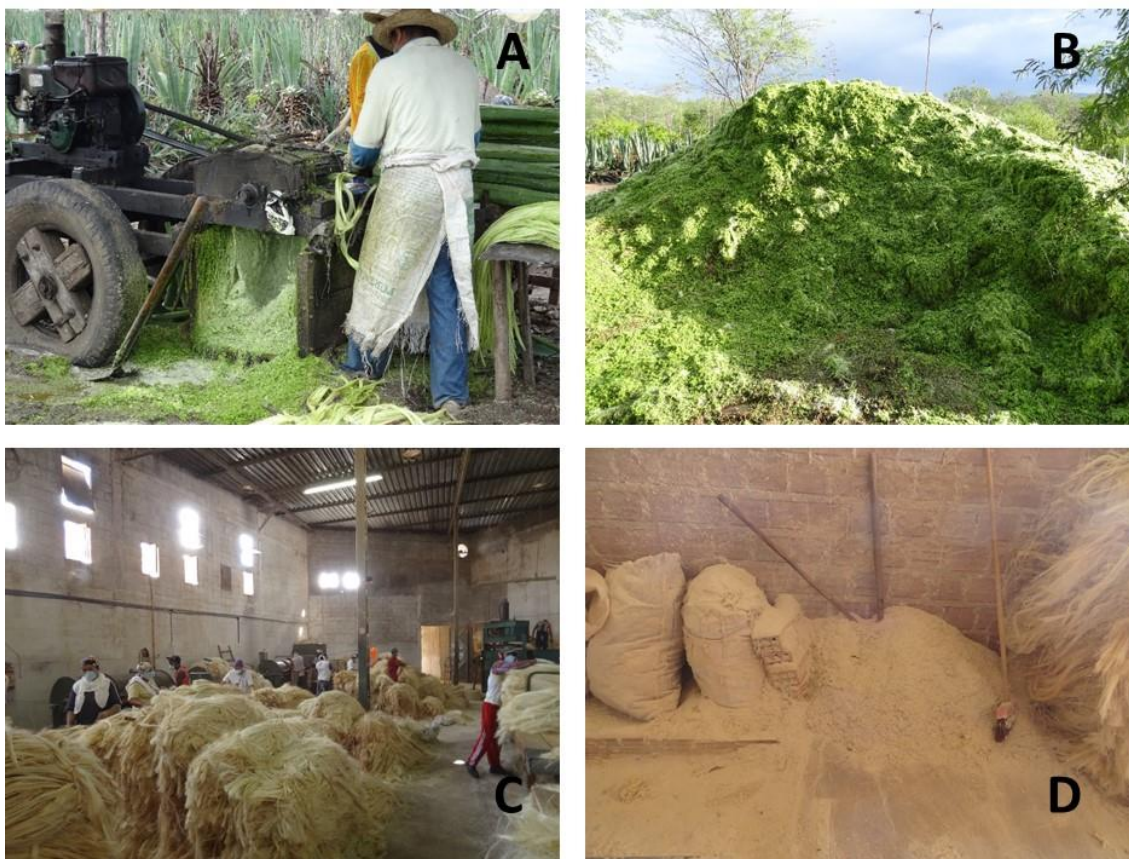
Figura 1: Subprodutos do desfibramento da folha do sisal e do processamento da fibra seca do sisal. A = Desfibramento da folha do sisal. B = Mucilagem da folha do sisal. C = Indústria de processamento da fibra seca do sisal, conhecida como batedeira. D = subproduto do processamento da fibra seca do sisal (pó de batedeira) no chão e armazenado em sacos.
