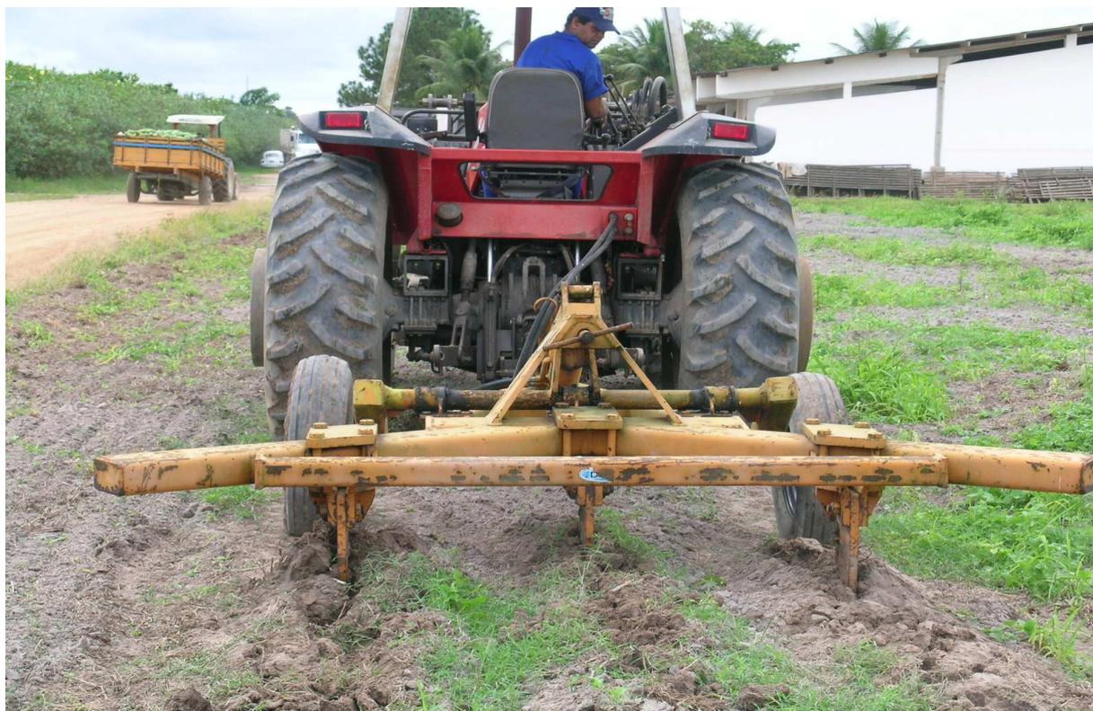
**Figura 2. Subsolador de três hastes subsoladoras, parabólicas e removíveis.**
