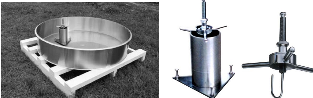
Figura 1 – Conjunto tanque Classe A completo (esquerda), poço tranqüilizador + micrômetro de gancho (centro) e micrômetro de gancho (direita).
