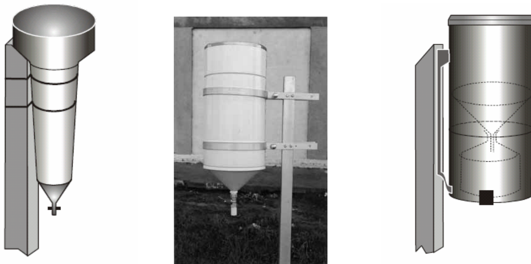
Figura 3 – Pluviômetros Ville de Paris (esquerda), Paulista (centro) e de Hellmann (direita). (Fonte: VAREJÃO-SILVA, 2001).
