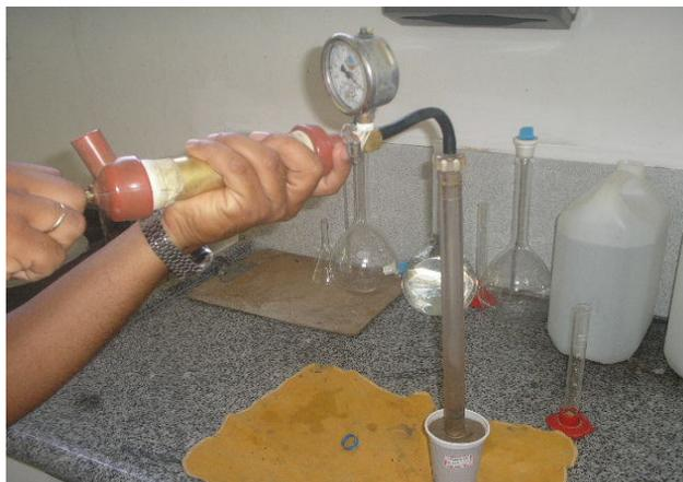
**Figura 6.** Aplicação de pressão negativa no interior dos extratores de solução.
