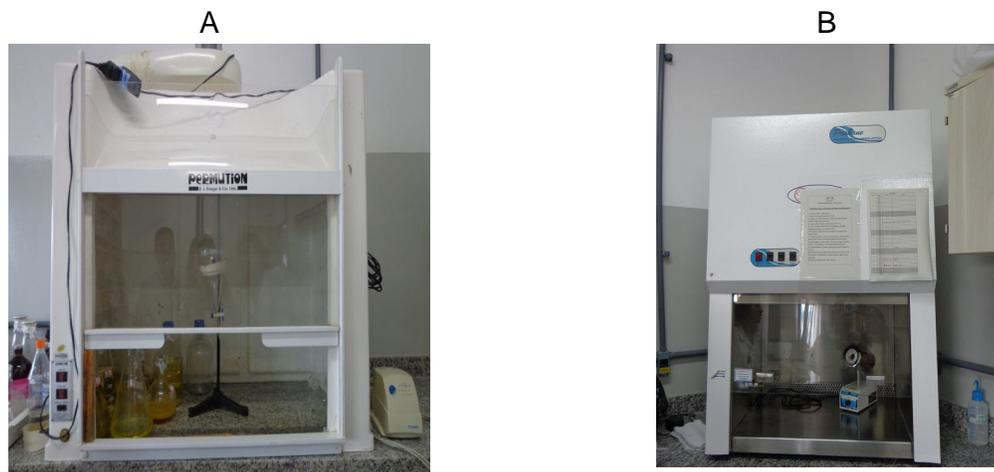
**Figura 2:** Capela de exaustão (A) e de fluxo laminar (B), respectivamente, em laboratório.
