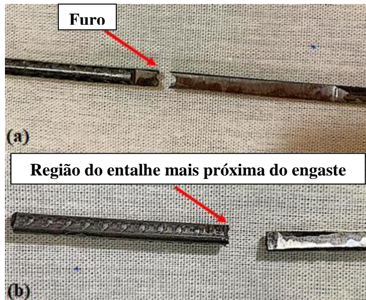
Figura 40: Regiões de ruptura dos corpos de prova
