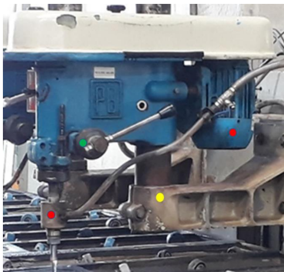
Figura 47: Identificação de pontos de rolamentos através de padrão de cores.
