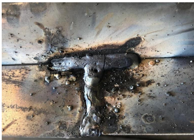
Figura 17. Fabricação de treliças: Porosidade, respingos, mordedura, sobreposição, e trinca em junta soldada
