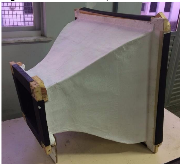
Figura 23 - Bocal de contração semiacabado.
