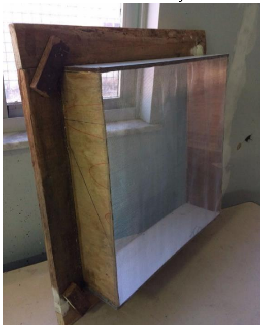
Figura 25 - Câmara de estabilização semiacabada.
