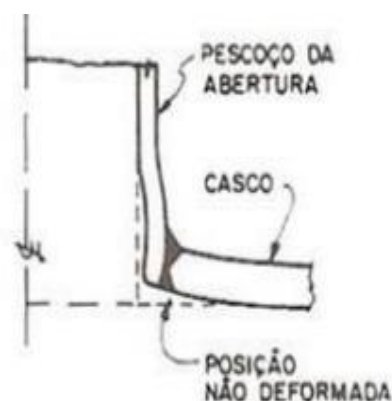
Figura 14: Deformação consequente de uma abertura. Fonte: TELLES (1996).
