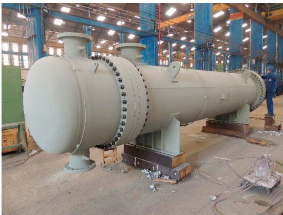
Figura 9: Trocador de calor casco e tubo em fabricação. Fonte: https://www.incase.com.br/trocador-calor-casco-e-tubo . Acesso em: 28/05/2019, às 10:23.
