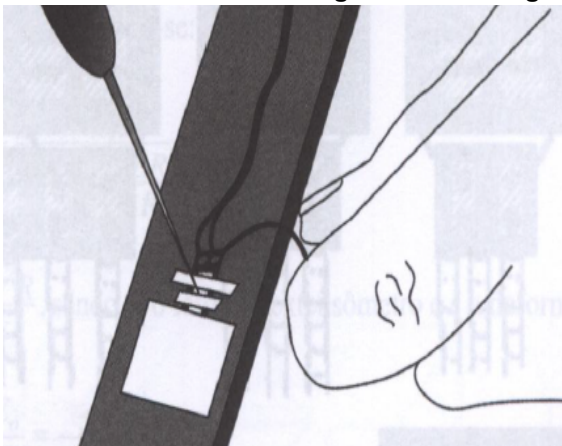
a) Soldagem dos condutores
