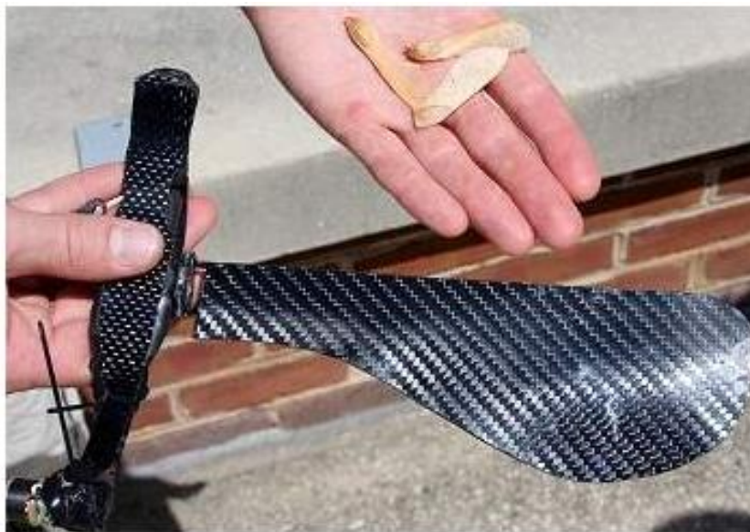
Figura 4 - Monocóptero inspirado em semente voadora.
