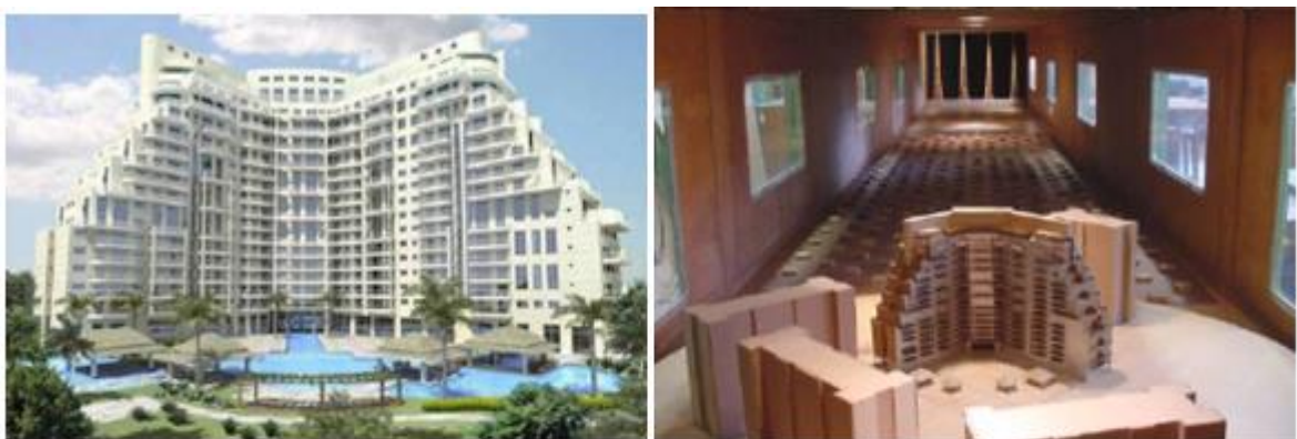
Figura 12- Modelo real e protótipo no interior do túnel de vento.
