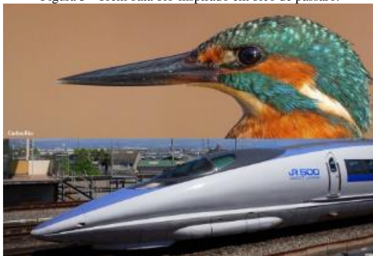
Figura 3 - Trem bala bio-inspirado em bico de pássaro.
