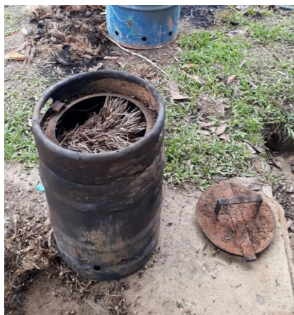
Figura 11: Reator aberto durante a inserção de resíduos
