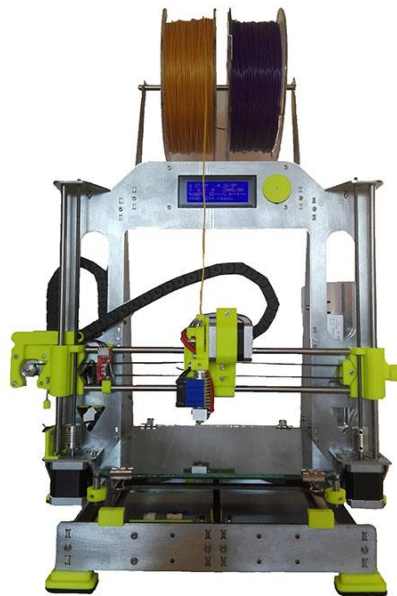
Figura 2.6 – Impressora 3D FDM baseada no projeto RepRap.
