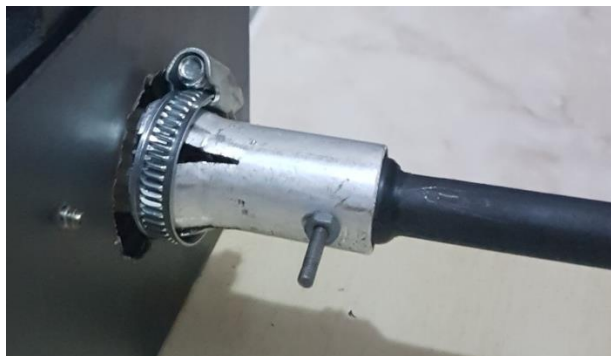
Figura 3.10 – Transmissão do motor para o parafuso de extrusão.
