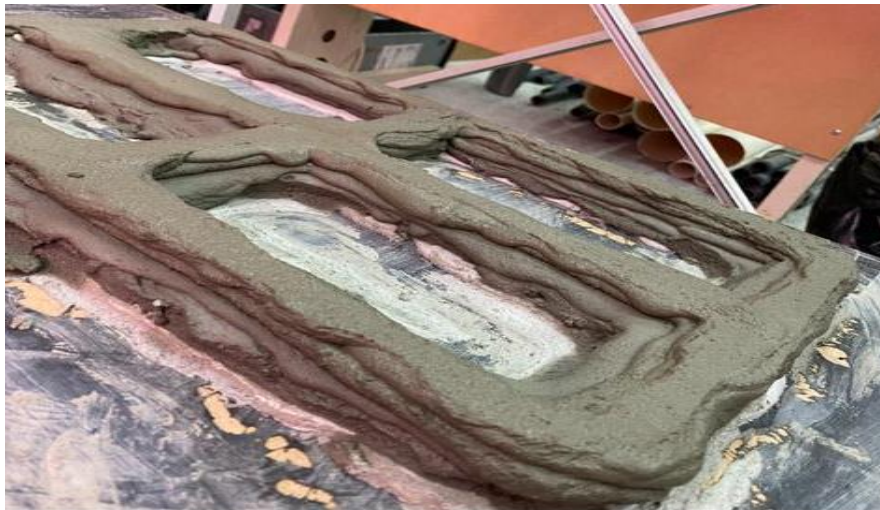
Figura 72. Primeira versão do segmento de parede impresso com o processo de extrusão manual.
