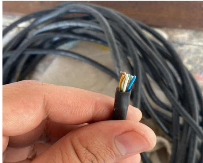
Figura 44. Cabo de rede Ethernet utilizado para as ligações.
