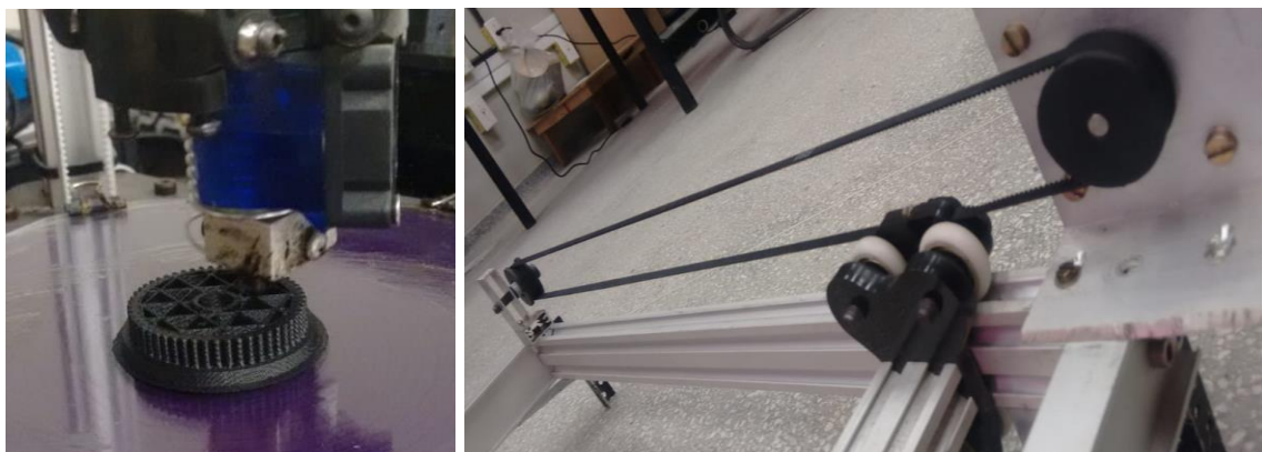
Figura 14. (A) Impressão da polia dentada. (B) Sistema de transmissão completo com as polias e correia.
