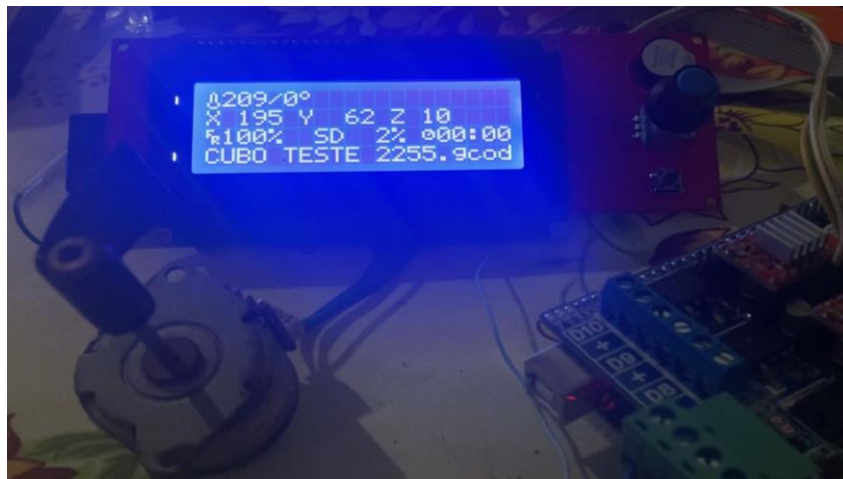
Figura 41. Registro de temperatura feito pela alteração da resistência do potenciômetro durante uma simulação de impressão.
