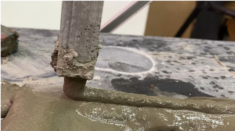
Figura 73. Deposição dupla da argamassa.
