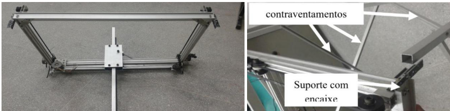
Figura 6 – Estrutura mecânica finalizada capaz de movimentar-se tridimensionalmente (a), inclusão dos suportes de apoio (b).
