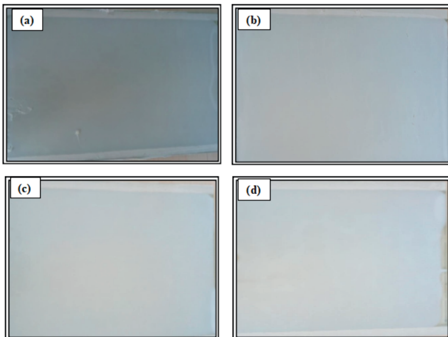
Figura 7: Fotos das membranas polimérica e híbridas: (a) PA pura/MgCl 2 , (b) PA/1% TiO 2 /MgCl 2 , (c) PA/3% TiO 2 /MgCl 2 e (d) PA/5% TiO 2 /MgCl 2 .
