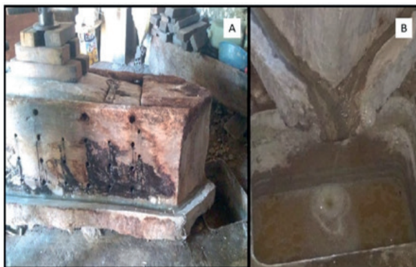
Figura 3 - Prensa de madeira utilizada na casa de farinha 2, na comunidade da Sapucaia. A: Prensa utilizada para preparo da farinha; B: Manipueira obtida após processo de prensagem.
