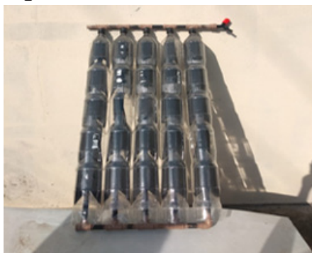
Figura 10 - Coletor de calor finalizado.
