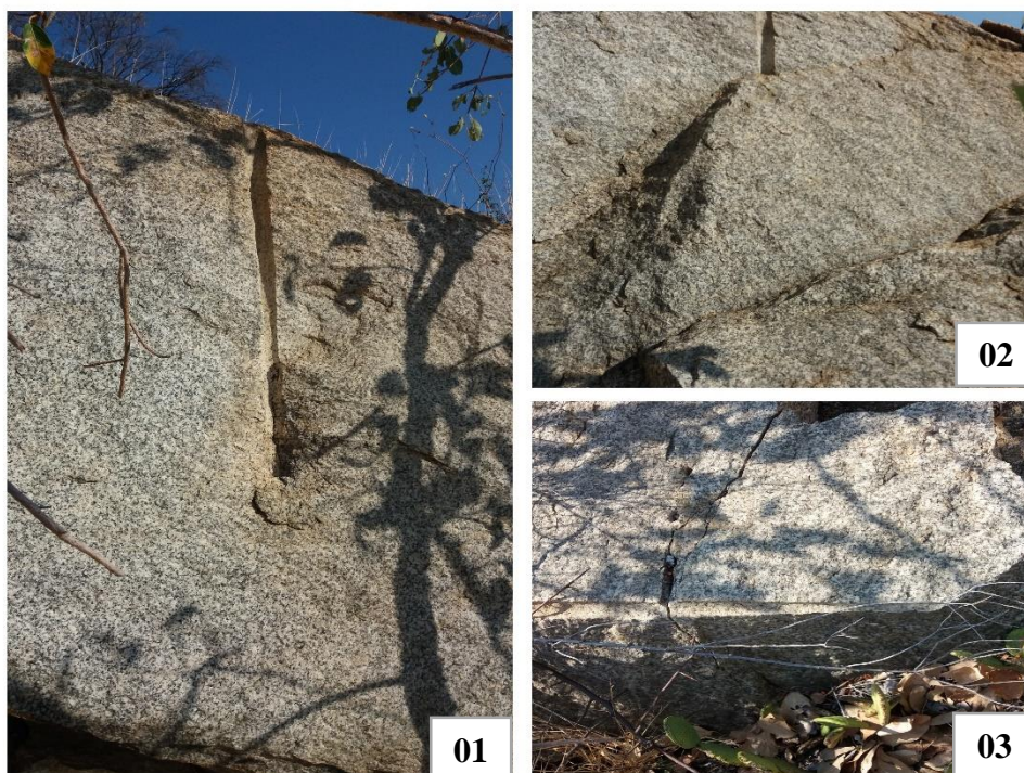
IMAGEM 37: Blocos de rocha implodido nas proximidades da unidade geomorfológica/arqueológica Pedra de Fogo. É possível observar a cavidade feita para a colocação dos explosivos. 1 suporte rochoso localizado na parte superior da unidade, 2 e 3 suportes rochosos situados na parte inferior da unidade, base do morro.
