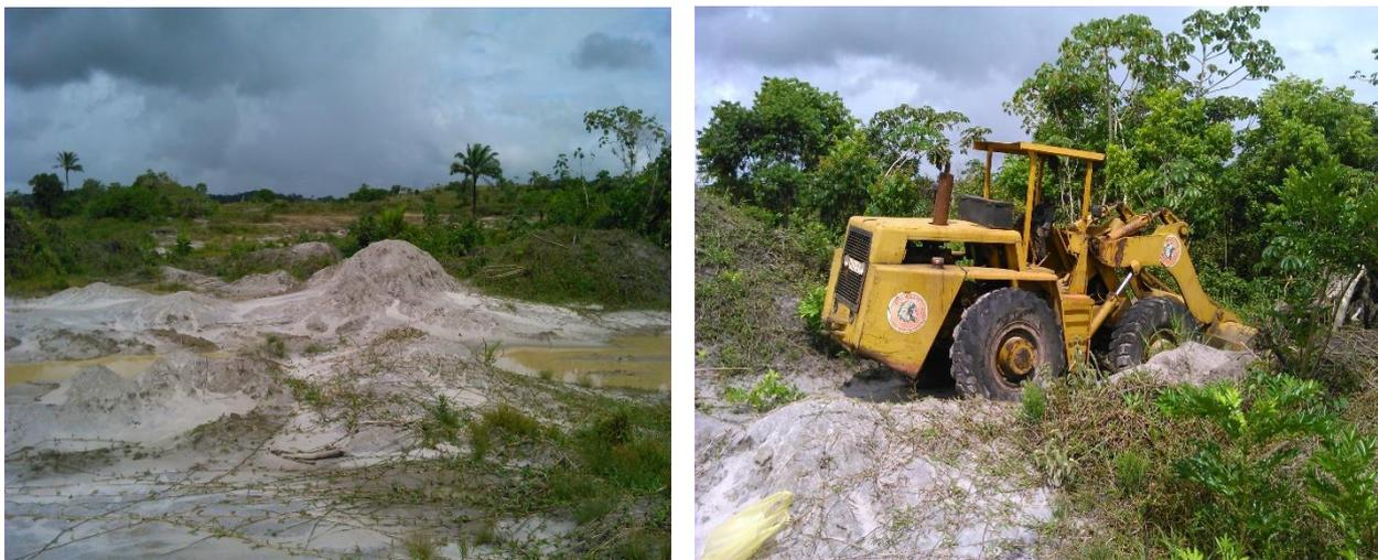
Figura 3.5- Lavra de areia suja e retroescavadeira utilizada na extração, Salinas das Margaridas.
