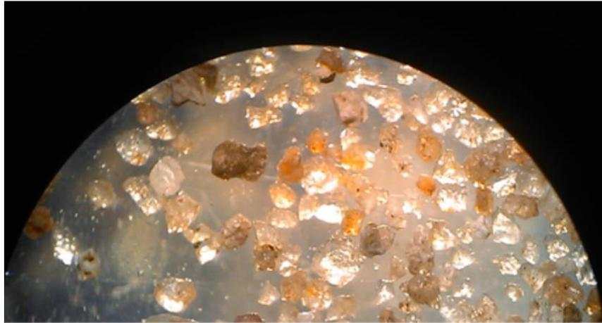
Figura 2.2- Amostra de areia lavada na lupa.
