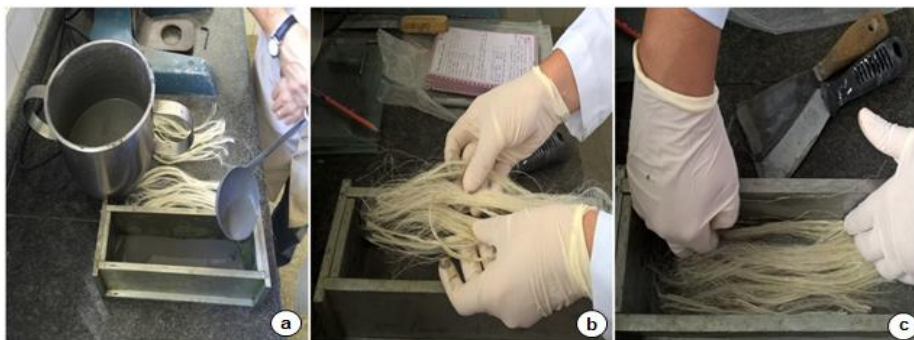
Figura 9. (a) Moldagem dos compósitos (b) Fibras longas (c) Aplicação das fibras na matriz.
