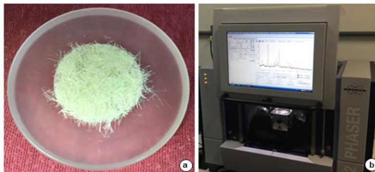
Figura 6. Ensaio de difração de raio-X: (a) amostra de fibra (b) equipamento
