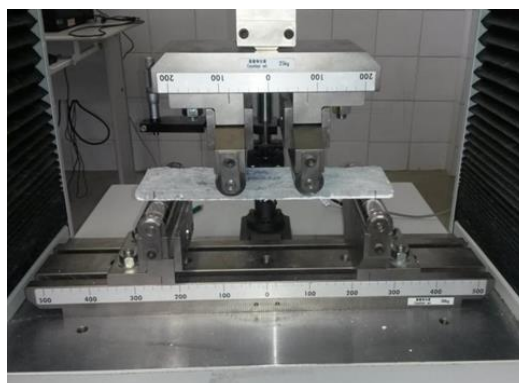
Figura 11. Equipamentos utilizados durante o ensaio de flexão em 4 pontos
