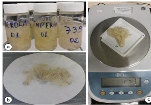
Figura 4. (a) Amostras imersas em água (b) Fibras secas superficialmente (c) Pesagem das fibras após imersão
