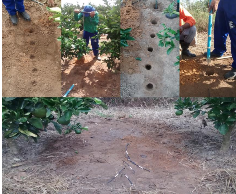
Figura 6. Instalação das sondas TDR.
