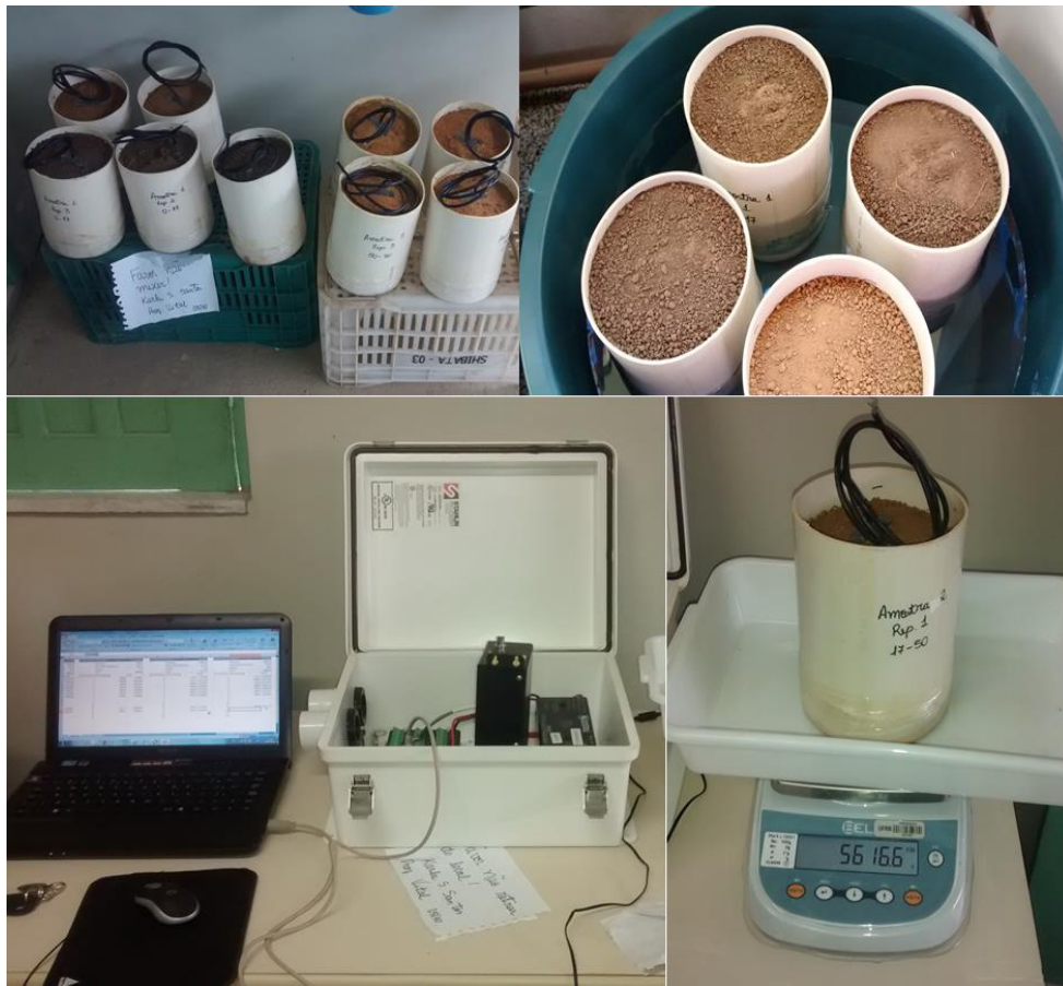
Figura 4. Calibração das sondas de TDR construídas. Saturação do solo e determinação do peso e da constante dielétrica.
