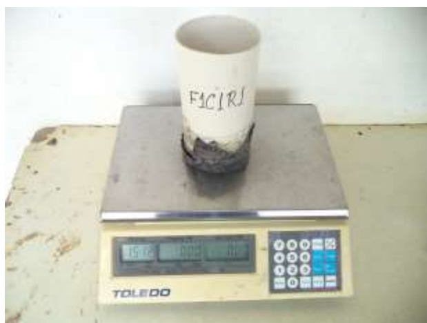
Figura 1. Monitoramento da umidade do solo nas colunas, pelo método gravimétrico, Cruz das Almas, BA, 2016.
